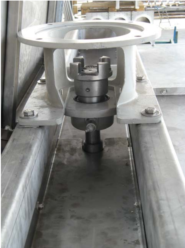
Motoraufnahme mit Rotex Kupplung und oberer Lagerung
