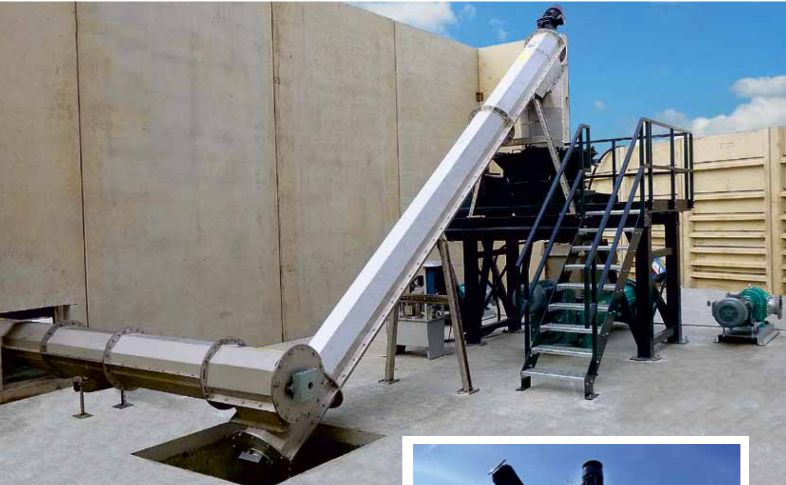
Convoyeur à vis sans fin, type 450 avec convoyage horizontal et incliné sur un dispositif de broyage
