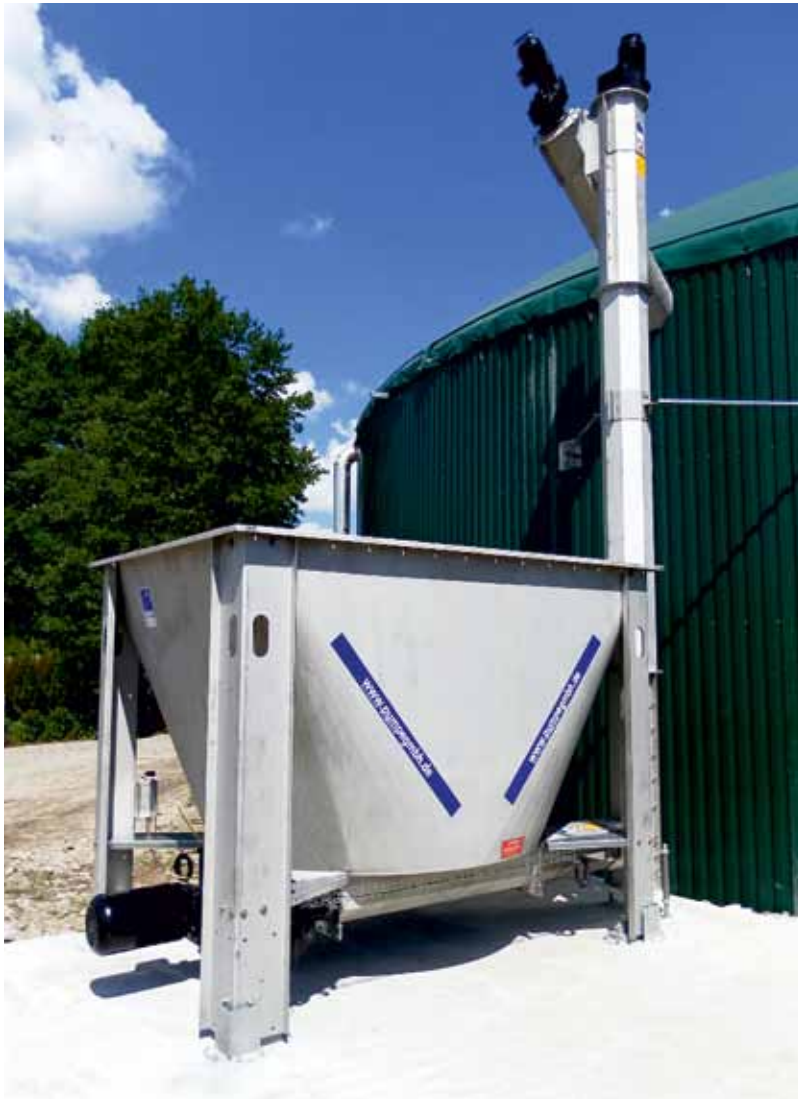
KOMBI-Mix 8000-8 m 3 avec technique de convoyage à vis sans fin, type 360K
