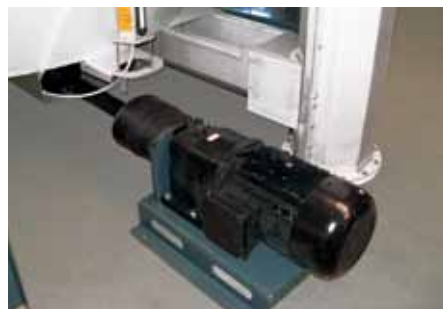
Entraînement via moto-réducteur, arbre articulé et réducteur angulaire à planétaires sur lame ou vis sans fin de mélange
